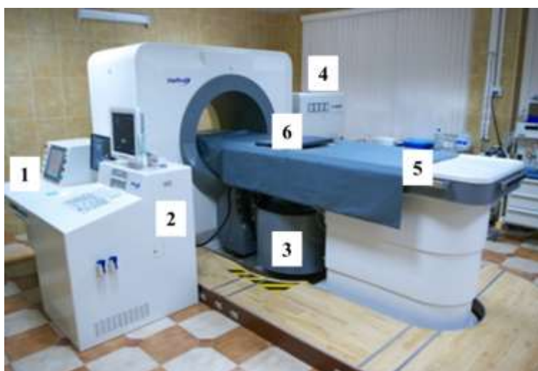
Рис.3. Общий вид установки HIFU. 1 - центральная панель управления, 2 - ультразвуковой сканер, 3 - кинематическая система, 4 - высокочастотный генератор, 5 - процедурный стол, 6 - лечебно - диагностический блок.
